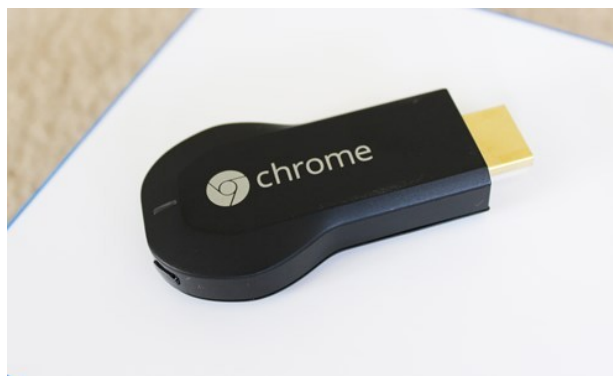
Chromecast tilsluttes til en af de ledige HDMI-porte i TV'et.
